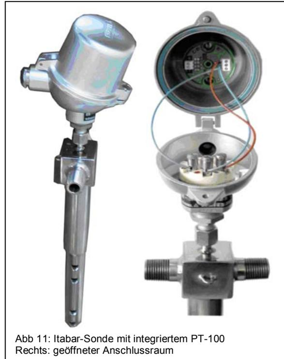
Abb 11: Itabar-Sonde mit integriertem PT-100
