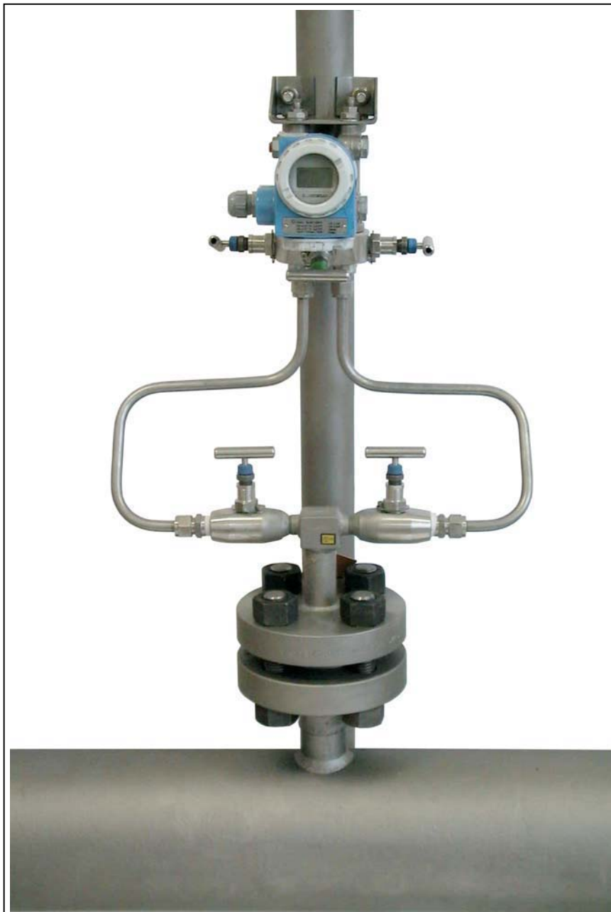
Abb.: 8.2: Staudrucksonde IBF-25 für eine Rohrleitung mit Innendurchmesser 146,3 mm. Der Differenzdruck- Messumformer ist getrennt montiert und durch Ermeterohre mit der Straudrucksonde verbunden.
