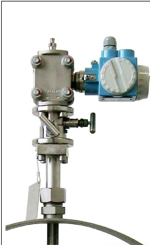
Abb. 6.1: Beispiel einer kompakten Version mit Flanschplatte, 3-Wege-Ventilblock und Differenzdruck- Messumformer
