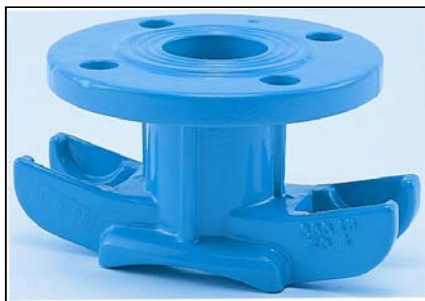
Abbildung 7.6: Universal-Anbohrschelle mit Flansch-Abgang DN 40/50 PN 4 (Gas) / PN 16 (Wasser)
