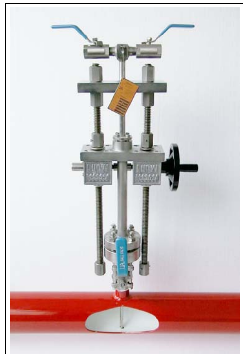
Abb.: 1.2: Unter Betriebsdruck einbau- und ausbaubare Staudrucksonde ITABAR FTM 20
