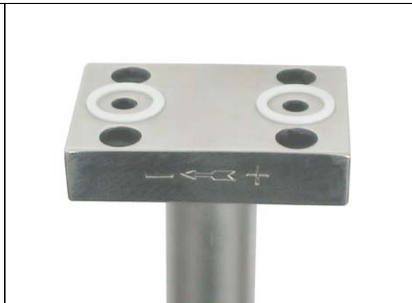
Abb. 7.2: Sondenkopf mit Flanschplatte zum Aufbau eines 3-Wege-Ventilblockes. Einsatzgrenzen ohne Isolierung der Rohrleitung: Gase bis P_{\max} = 63 bar und T_{\max} = 200 °C Flüssigkeiten bis P_{\max} = 63 bar und T_{\max} = 150 °C
