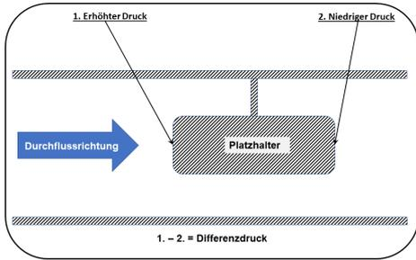
Wenn ein Objekt in ein laminar fließendes Medium in einer Rohrleitung eingebracht wird, staut sich das Medium in Front des Objekts auf, was zu einem Anstieg des Druckes führt. Beim Vorbeifließen am Objekt, bedingt durch die Verengung des Rohrquerschnitts, wird das Medium beschleunigt. Diese Beschleunigung erzeugt einen Druckabfall an der Rückseite des Objektes. Nachdem alle Betriebsbedingungen an der Messstelle bekannt sind, kann aus der Differenz dieser Drücke der Volumenstrom berechnet werden.
